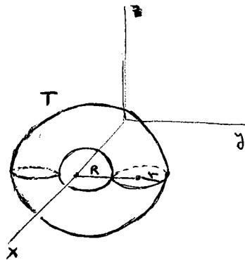
$$\begin{cases} r = \text{radi de la secció circular}, \\ R = \text{distància del centre de la secció circular a l'eix de gir}. \end{cases}$$
