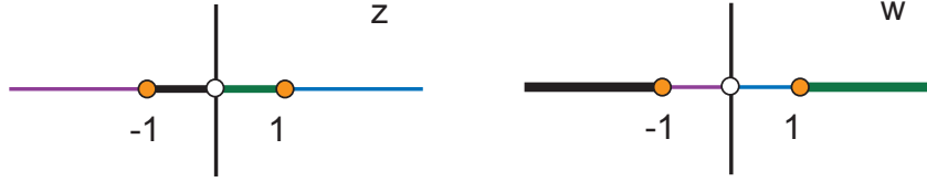
Figura 5.2: L'eix real es transforma en ell mateix per w = \frac{1}{z} .
